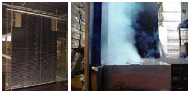
窓面付近の風の流れを可視化（スモークマシーンを利用）
