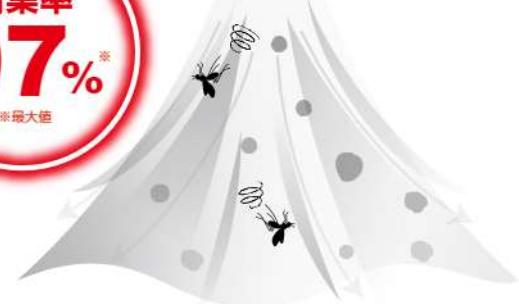
前面の吸込み口から風が入り込み、旋回翼(サイクロン)に遠心力が引き起こることで、スリットからゴミや虫が落ちる構造です。
